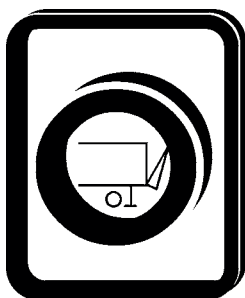
Włączanie urządzenia Cargolift dla samochodu ciężarowego w kabinie kierowcy
